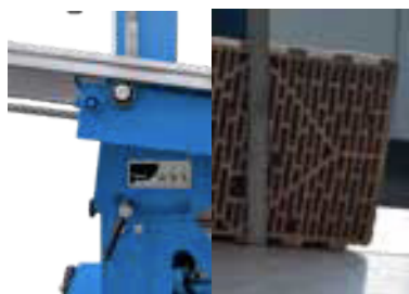
Taglio inclinato su mattoni con cavità vuote
