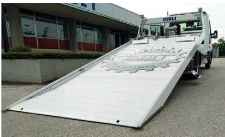
ISOLI MSR 10 è un nuovo e innovativo carro soccorso caratterizzato da un pianale fisso in alluminio montato su telaio AL-KO AMC a 3 assi con pneumatici da 13" sugli assali posteriori.
