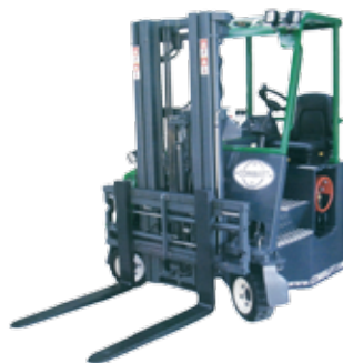
CARRELLO ELEVATORE MULTIDIREZIONALE PORTATA 30 - 40 Q.LI | DIESEL | ELETTRICI
